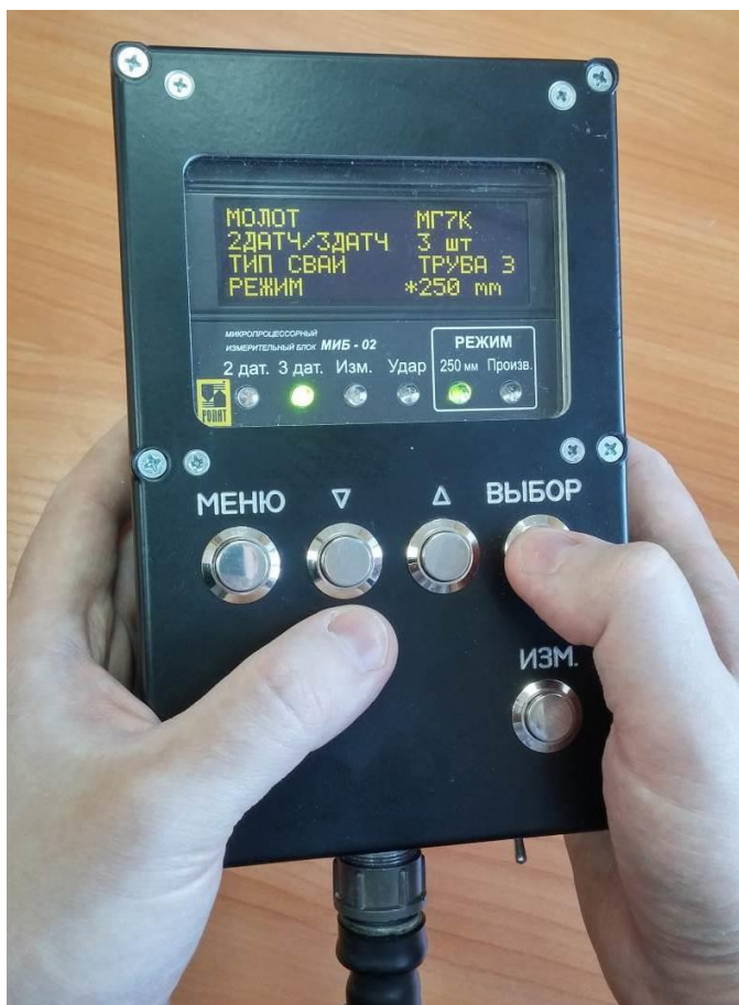
Рис.3 Прибор МИБ-02 для измерения предельного сопротивления сваи
